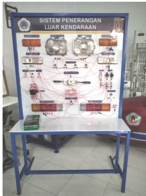
Gambar 2. Trainer system penerangan luar kendaraan
