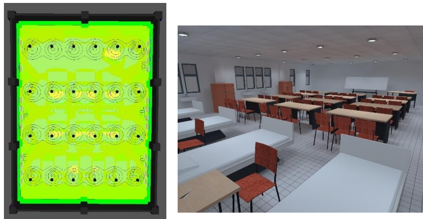
Gambar 14. Hasil Simulasi dan Perspektif dengan menggunakan 24 unit lampu single downlight merk Philips
