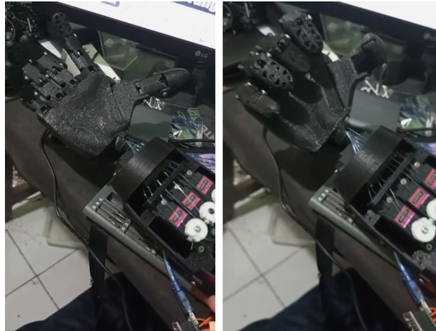
Gambar 3. Hasil implementasi tangan robot anthropomorphic: struktur jari cetak 3D bermekanisme tendon (kiri) dan bank servo penggerak dengan puli tendon pada segmen lengan (kanan)
